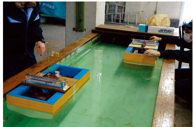
図-2 模型船を使った傾斜試験（下げ振り）実習
