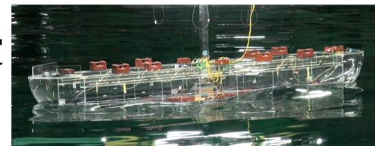
弾性模型船を用いた水槽試験
