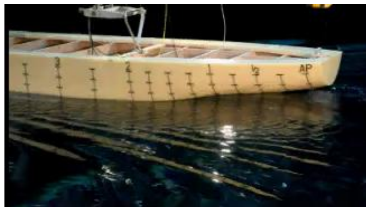
FBG圧力計測の様子と計測値（左：圧力センサ、中央：試験の様子、右：圧力計測値）
