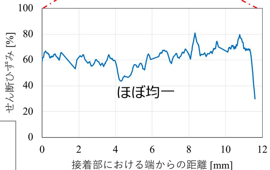
より均一なひずみ分布を取得でき、正確なせん断特性評価が可能
