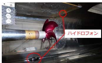
第一計測部におけるハイドロフォンの配置
