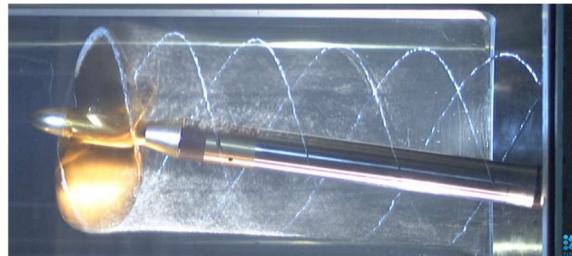
ストロボと連続光を用いた後流写真
