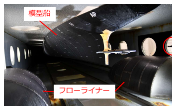
第二計測部における模型船とハイドロフォンの配置 (左図：船尾側から模型船を見た様子、右図：船尾のプロペラ直上の様子)
