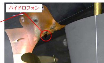
第二計測部における模型船とハイドロフォンの配置 (左図：船尾側から模型船を見た様子、右図：船尾のプロペラ直上の様子)
