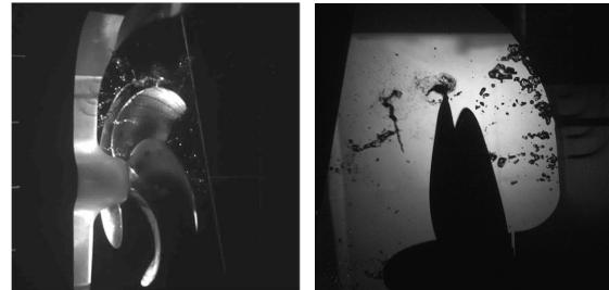
気泡流中キャビテーション観察 気泡径計測(シャドウグラフィ) 計測条件： n_p=20\text{rps} , K_T=0.201 , \sigma_p=2.990 (実船： N_p=163\text{rpm} ) 空気吹出：Ch.6 (1.2R), Q=0.5\text{L/min}
