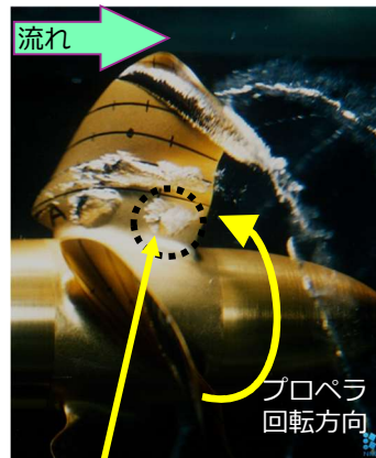
プロペラ背面に発生した雲状のキャビテーション (クラウドキャビテーション)
