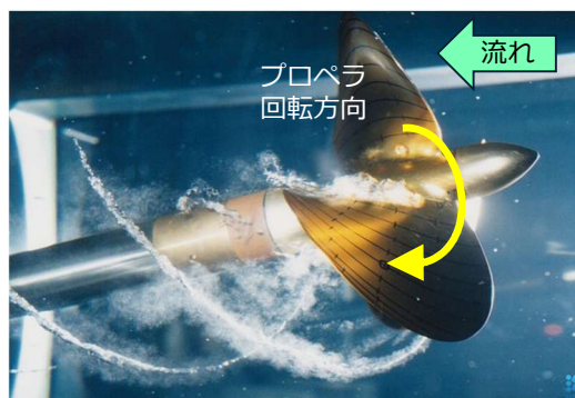
翼根部に発生したキャビテーション（ルートキャビテーション）
