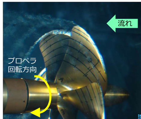
プロペラ正面に発生したキャビテーション（フェースキャビテーション）
