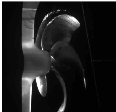
ハイスピードカメラによるキャビテーション観察 計測条件: n_p=20\text{rps} , K_T=0.212 , \sigma_n=2.710 (実船: N_p=171\text{rpm} )
