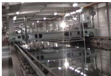
中水槽でのVIV計測試験の様子
