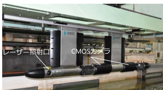
曳航水槽用ステレオPIV計測装置
