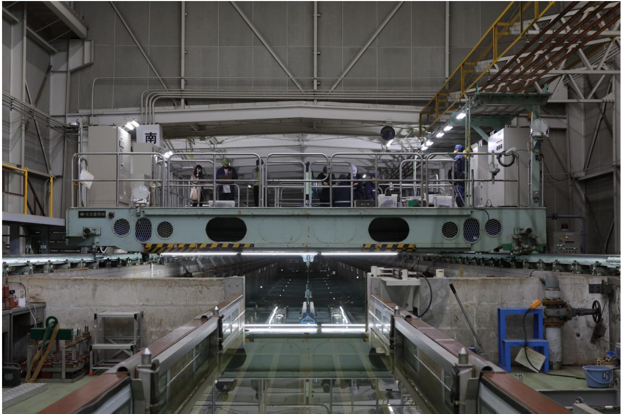
曳航台車をトリミングタンクより見る
