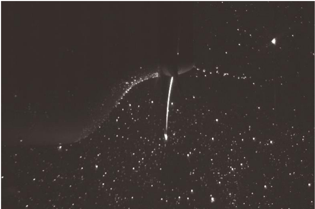
マイクロバブルを用いたPIV計測（CWレーザー方式）
