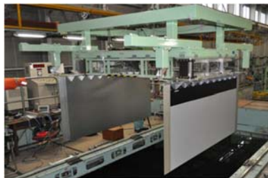
平行平板曳航法による2m平板の評価試験
