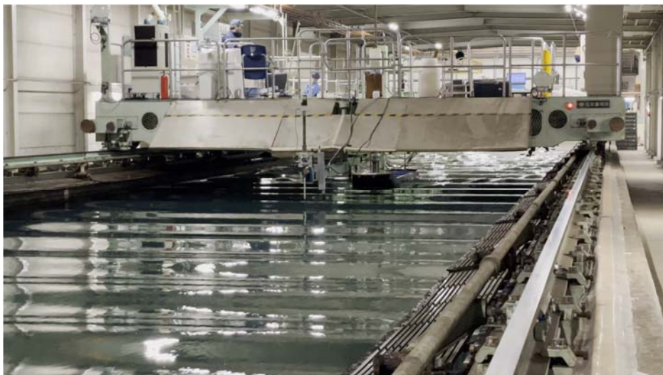
実験風景（波高実船相当3.0 [m]、 \lambda/L=0.4 ）
