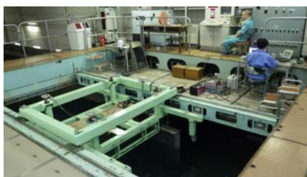
平行平板曳航装置計測状態
