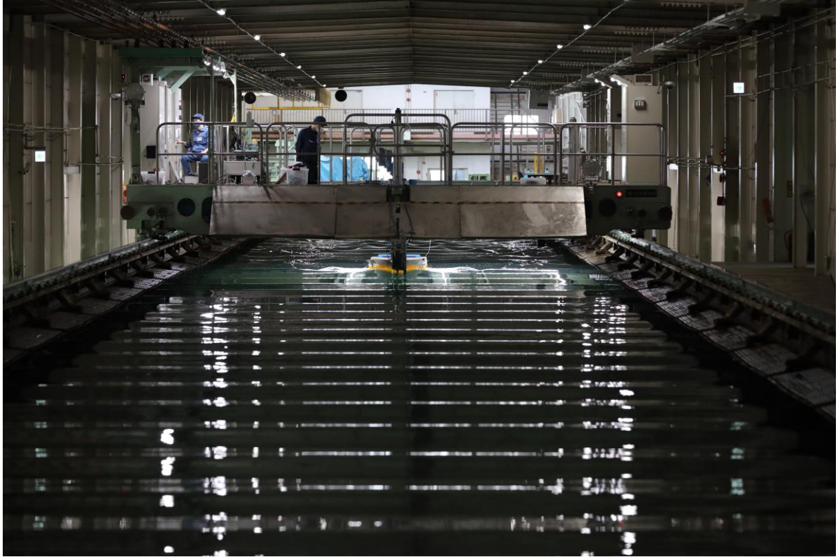
波浪中水槽試験を船首正面より見る
