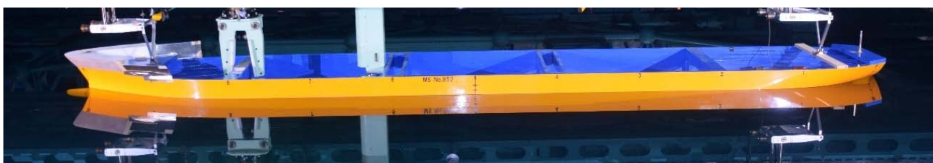
ケミカルタンカー模型船（船長6.2m）
