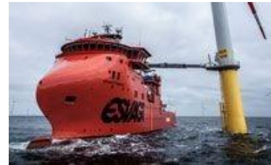
作業員・資材輸送に用いるSOV [欧州仕様] (ESVAGT)
