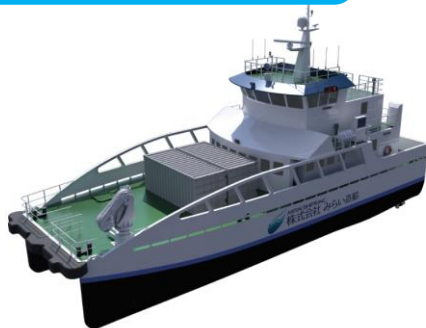
作業員輸送に用いるCTV (みらい造船)
