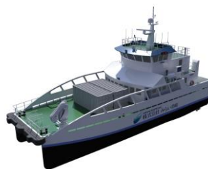
作業員輸送に用いるCTV (出典：みらい造船) (CTV：Crew Transfer Vessel)
