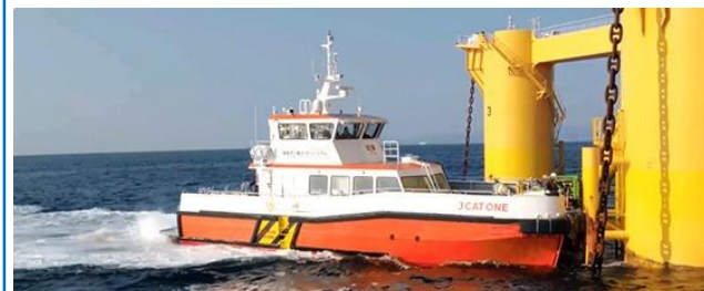
CTVによる洋上風車への接続(東京汽船)
