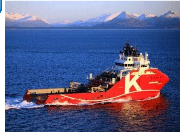
アンカー設置に用いるAHTS [欧州仕様] (川崎汽船)
