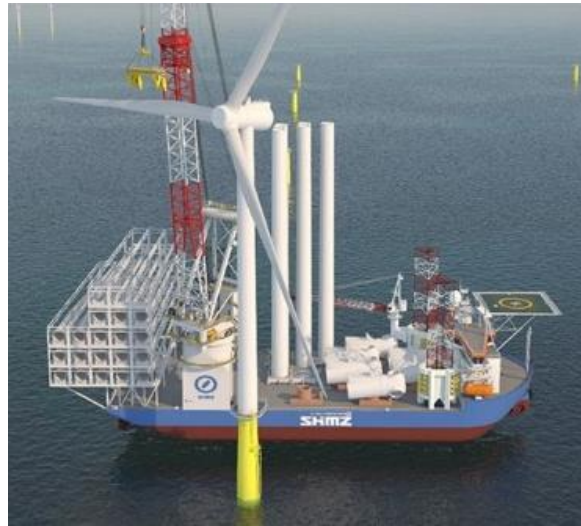
設置工事に用いるSEP船 (清水建設)
