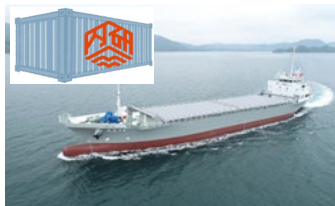
国喜68(國喜商船) バッテリー容量:200 kWh (コンテナ型) 荷役・停泊に利用
