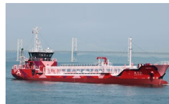
あさひ(旭タンカー) バッテリー容量:3,480 kWh 推進・荷役・停泊に利用
