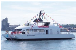
HANARIA(MOTENA-Sea) バッテリー容量:450 kWh 推進に利用 (ハイブリッド)
