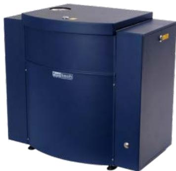
着火性計測用実験装置
