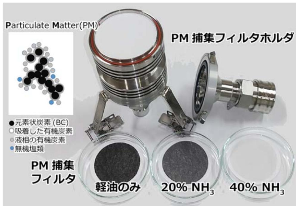
アンモニア・軽油混焼時のPM捕集状況
