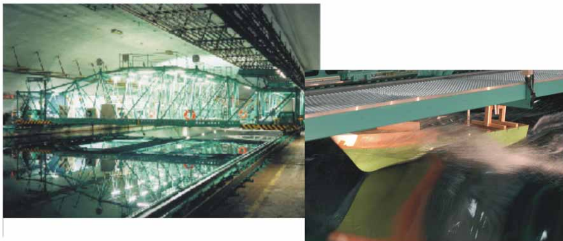
400m 試験水槽と高速艇波浪中実験
