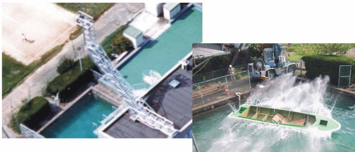
救命器具落下試験設備と FRP 接合船落下衝撃試験（大阪）
