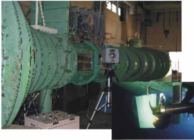
船尾変動圧計測 大型キャビテーション試験水槽
