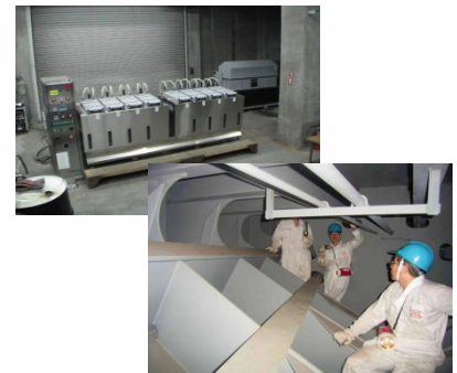
ウェーブタンク塗装試験装置(上)とボイドスペース実船調査(下)
