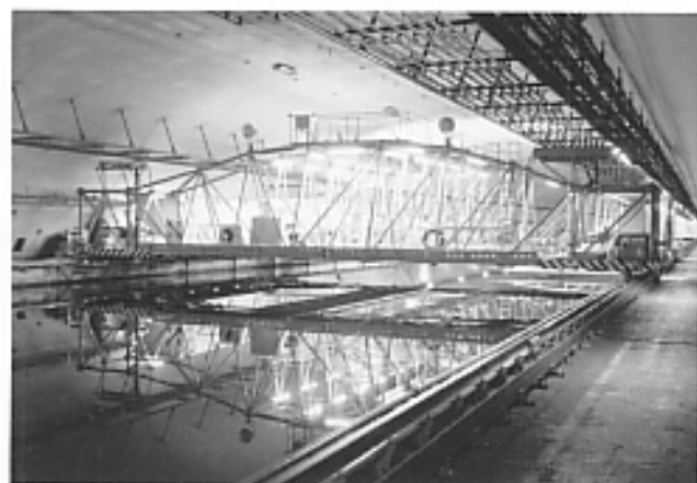
速度制御装置等が新しくなった曳引車
