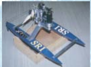
特殊な出力制御機構を持つスターリングエンジンを搭載した模型ボート
