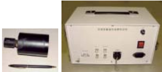
画像伝送用の送受波器(左)と受信装置(右)
