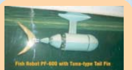
初期の実験用魚ロボットは、胴体の上方にフロートを取り付け、一定の深度で運動する形式でした。これらの尾ひれの運動パターンをパソコン制御することで、遊泳速度や旋回性能など、魚ロボットの基本性能を調べました。
