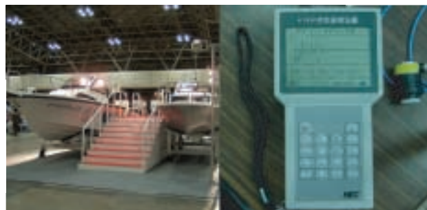
リユース可能なFRP船 (左：発泡構造船、右：ブロック接合船)と劣化診断装置
