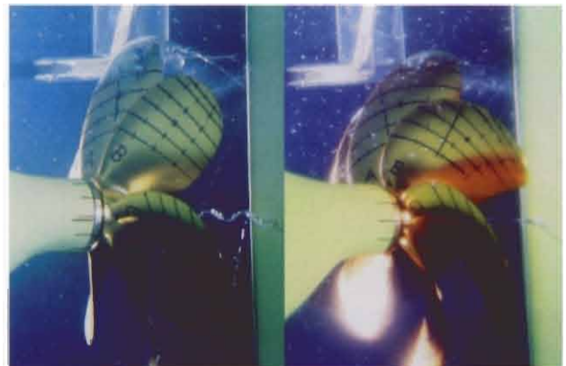
写真1 キャビテーションの比較 (左: 原型プロペラ、右: 改良プロペラ)
