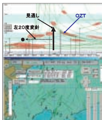
図3 OZT表示 (操縦性能D、速力40ノット) OZT (自船行動妨害ゾーン)の隙間が直線上に存在するとともに、前方1マイル先で左20度(●)に隙間が存在する。
