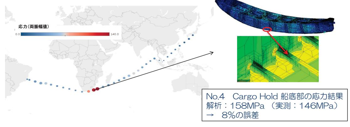
実海域で生じる構造応答を概ね推定できる
