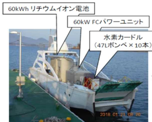
船用燃料電池推進システムを搭載した 実験船(平成29年度)
