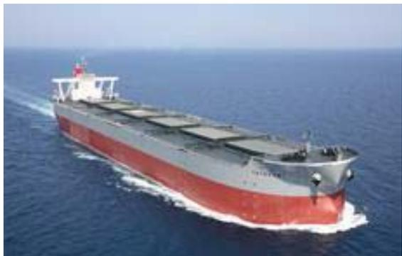
30万トン型鉄鉱石運搬船
