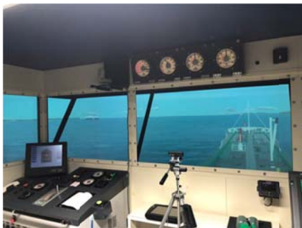
写真1: 操船リスクシミュレータ船橋
