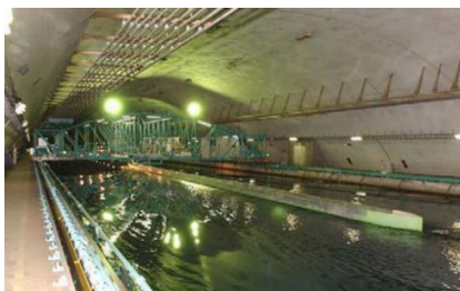
400m 水槽での長尺模型実験
