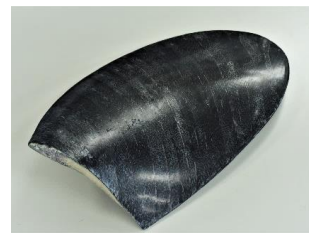
繊維配向を制御した CFRP 模型翼
