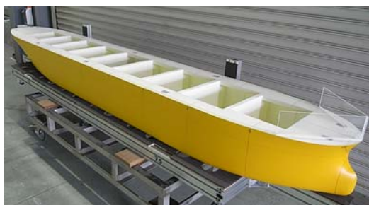
バルクキャリアの構造を模した FRP 製模型
