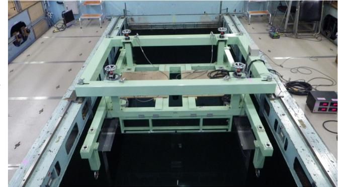
中水槽計測桁を拡げて設置
