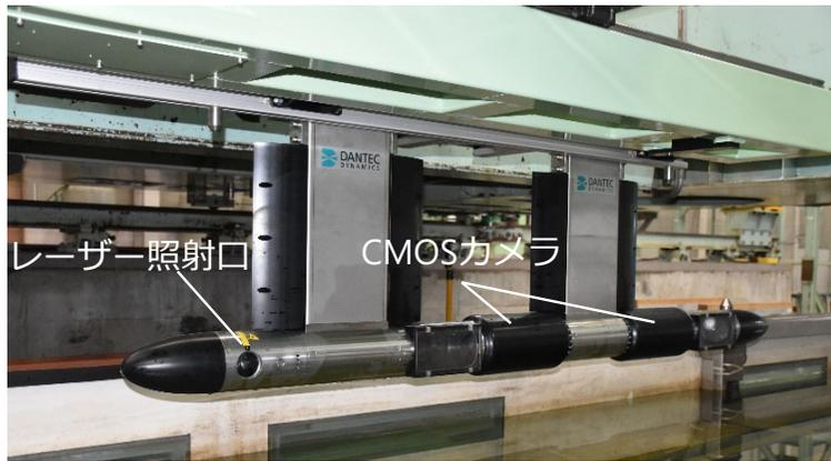
曳航水槽用ステレオPIV計測装置
