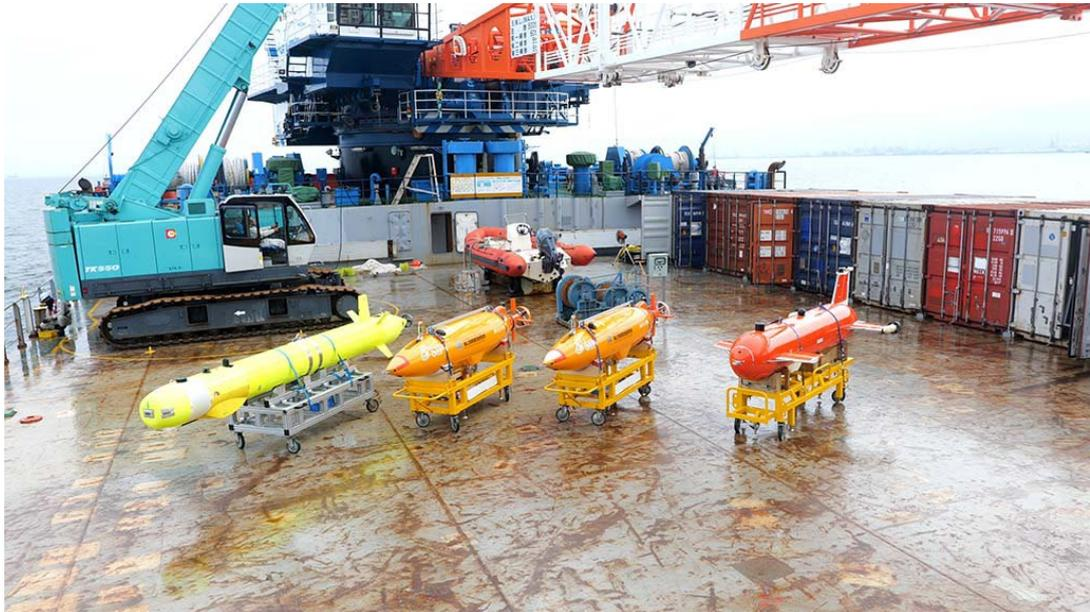
図2. 隊列制御を行った4機のAUV
