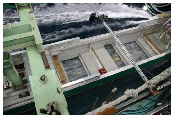
空気潤滑試験の様子（長尺平板模型船を上方を見る）
