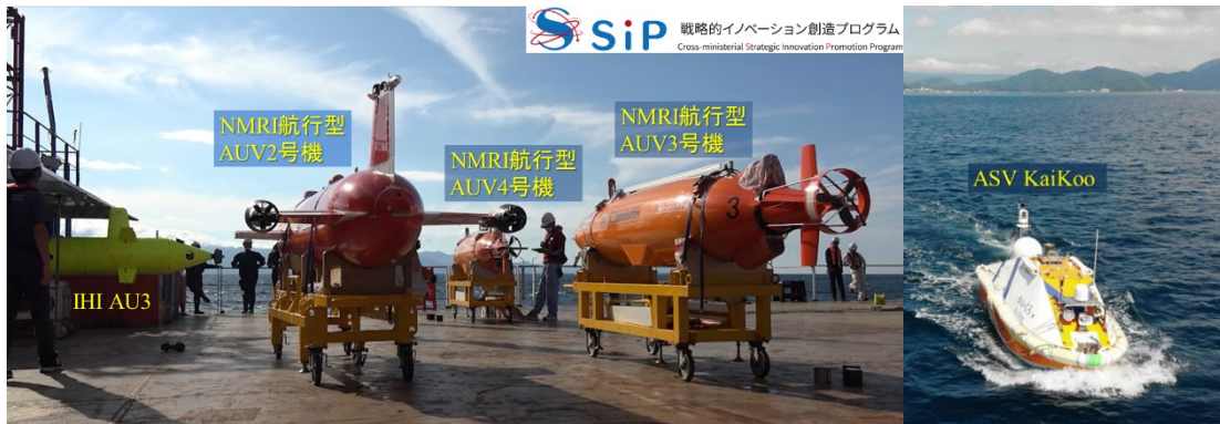
図 1. 異機種 AUV4 機、ASV1機で構成した海底調査ユニットによる複数 AUV 隊列制御実海域試験の様子
