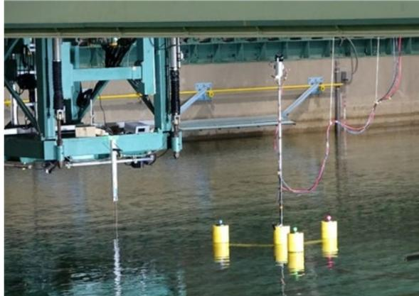
図 浮体式風車の模型
