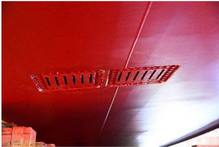
写真4 船底の空気潤滑吹き出し部
