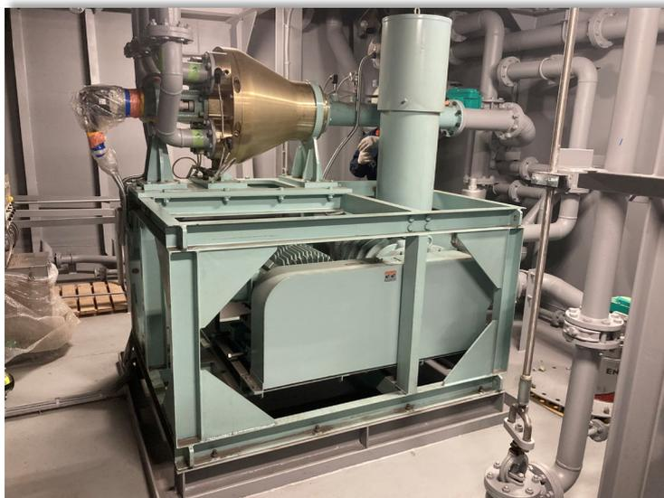
写真3 空気潤滑システム(ブロワ、周期吹き出し装置)
