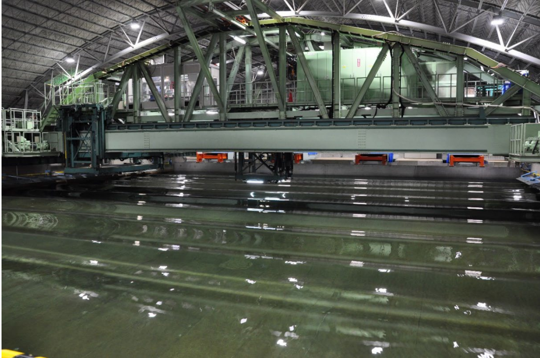
海洋構造物試験水槽
