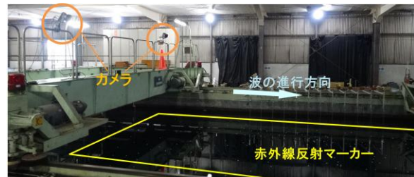
図-1 動揺水槽におけるカメラ及びマーカーの設置の様子 2)
