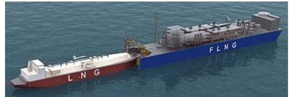
図2 洋上ドッキングシステムによる LNG 出荷 2)
