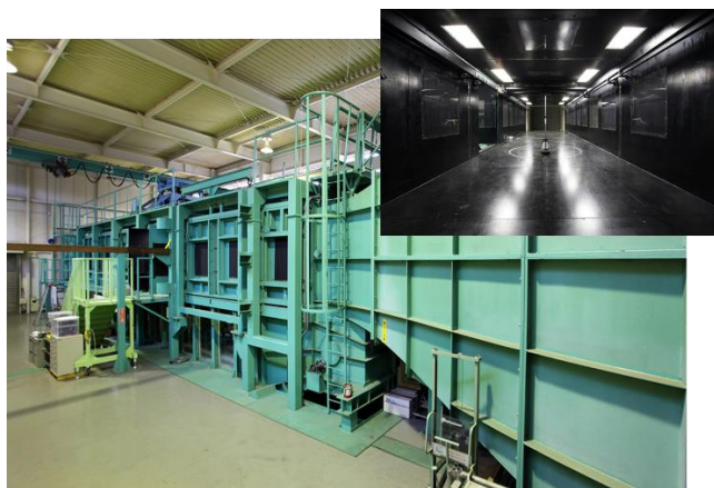
図1 試験設備(変動風水洞)
