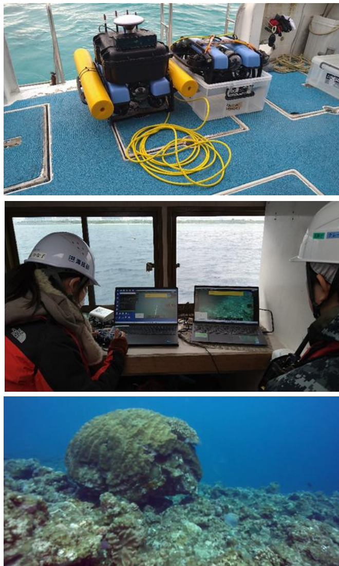
図 AUV-ASV 連結システムの外観（上）、船上運用の様子（中）、AUV 水中映像の例（下）
