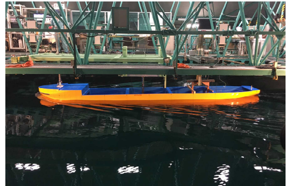
400m 水槽での模型試験 (模型船長 7m)
