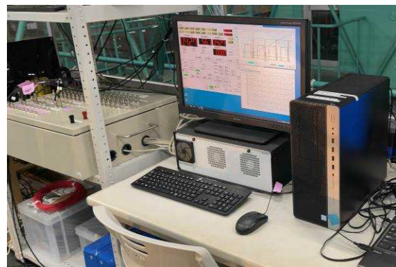
400m 水槽での自動計測による試験 (左：制御装置、右：制御ソフト)
