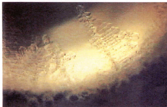
写真7 ステンレス網 (図22参照) から成長した析出クラスレート
