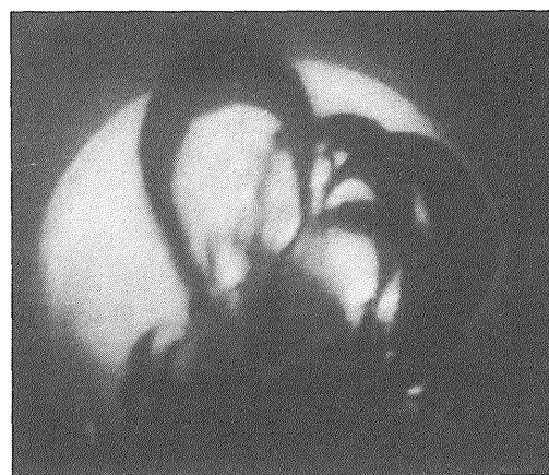
写真4 注入法によるクラスレート生成の差異
