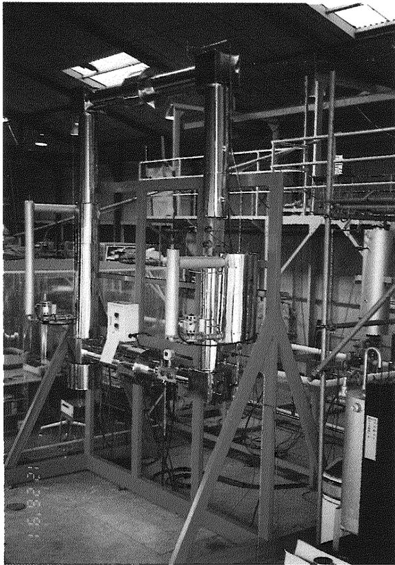
写真2 CO<sub>2</sub>深海貯留模擬実験装置
