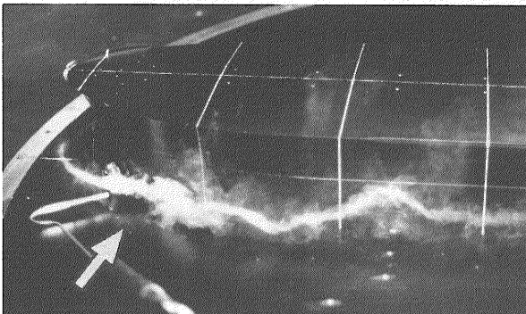
図3-46 スモーク法による馬蹄渦 (A) の可視化写真 ( \psi = 40^\circ )
