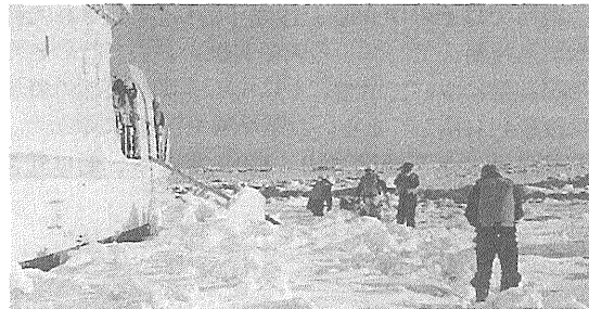
写真-2.4 氷盤上で氷厚及び積雪厚を計測
