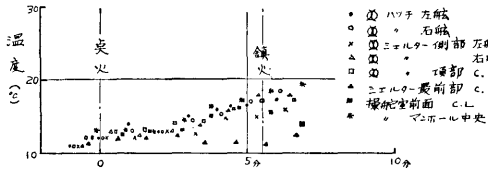
図 7.19 断熱材内表面温度 (B実験)
