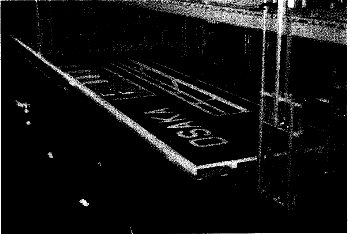
浮体式海上空港の大型模型による水槽実験
