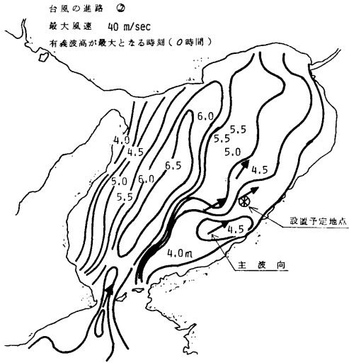
図 2.15 モデル台風のシミュレーション計算による大阪湾の有義波高
