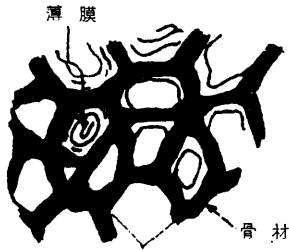
図3 フォーム材の内部構造
