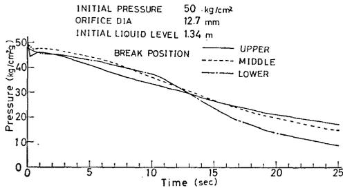
図 3-2 破断口位置と圧力特性
