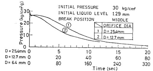
図 3-9 破断口径と圧力特性の関係
