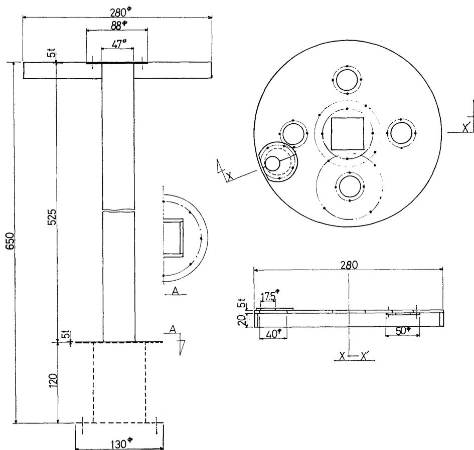
図 2-3 内部構造物 主要寸法
