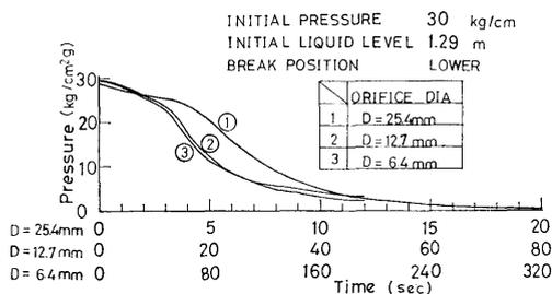
図 3-11 破断口径と圧力特性の関係
