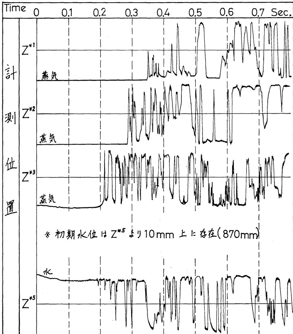
図 2-12 破断直後のボイド計記録例
