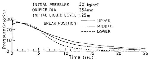
図 3-4 破断口位置と圧力特性
