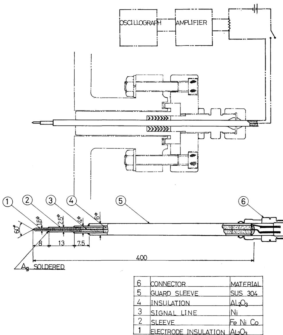
図 2-7 触針式ボイド計原理図
