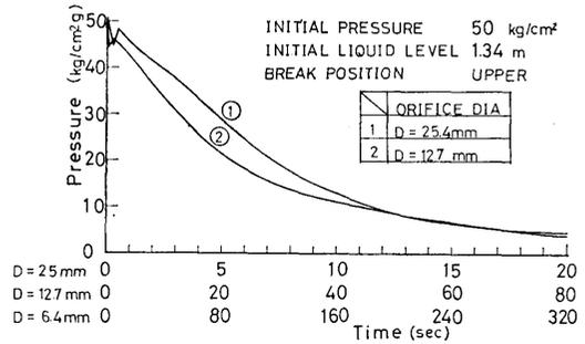
図 3-6 破断口径と圧力特性の関係
