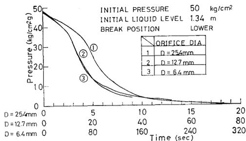
図 3-10 破断口径と圧力特性の関係
