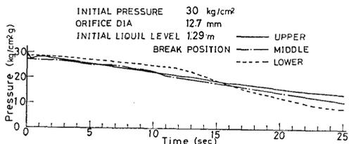
図 3-5 破断口位置と圧力特性
