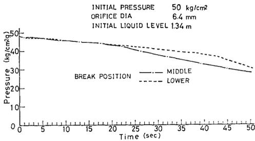
図 3-3 破断口位置と圧力特性
