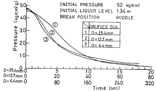
図 3-8 破断口径と圧力特性の関係
