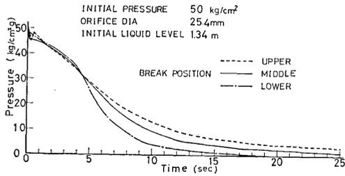
図 3-1 破断口位置と圧力特性
