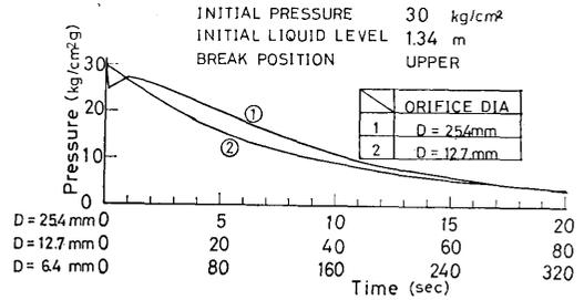
図 3-7 破断口径と圧力特性の関係
