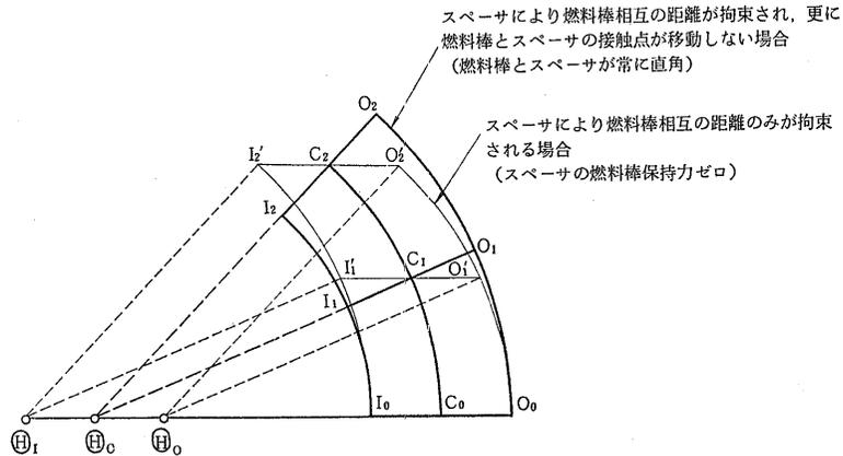
図-4.8 燃料集合体のたわみモデル
