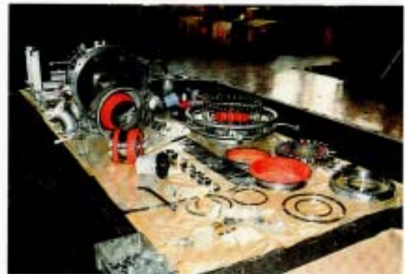
(c) 組立前の試験タービン部品
