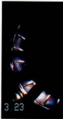
(b) 主空気流量 2.8\text{kg/s} 、再熱水素流量 1.5\text{g/s}
