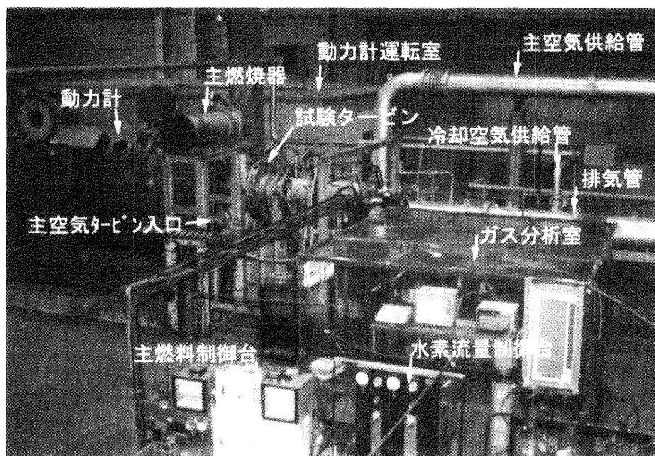
写真6 タービン試験装置全景
