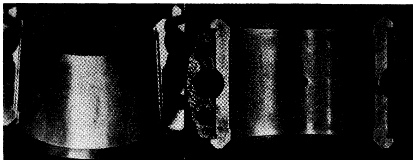
写真 11 SS 4 機関クランクピンメタル運転前
