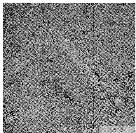
写真-11 WOL 試験片疲労破壊部のマイクロ写真 (レプリカ採取位置 4, 透過型電顕) 見なれぬ様相を呈している。原因不明
